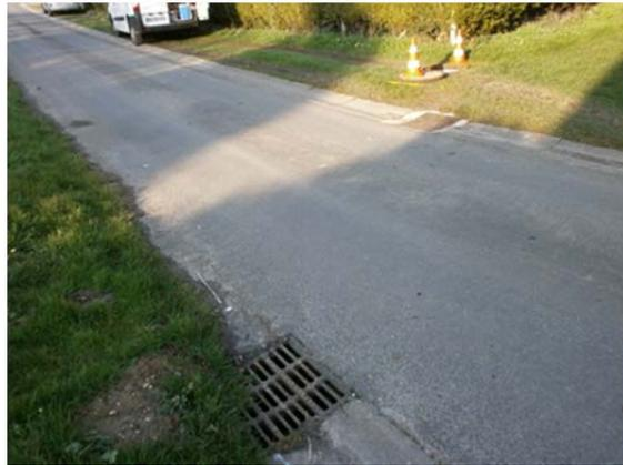
Le ru longe la Sente de la Brisoire sur 4,5 m sous la forme d'une buse Ø500, avant de se transformer en ru à ciel ouvert.
